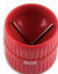
Para avellanar el exterior del tubo
